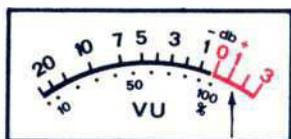
Das Anzeigefeld enthält eine logarithmische Skala in db-Eichung und eine lineare Skala in Prozenten.
