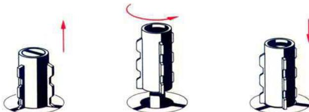
Wenn die Bandspulen richtig auf den Spulentellern aufliegen, können sie durch Anheben und Drehen des Mitteldornes der Dreizackführung verriegelt werden.
