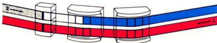
Nach erfolgtem zweiten Durchlauf ist das Tonband bei Halbspur-Aufzeichnung gefüllt.
