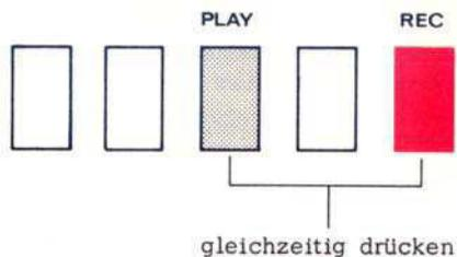
Nun läuft das Tonband auf Aufnahme (Spur 1). Eine alte Aufzeichnung auf Spur 1 wird dabei automatisch gelöscht. Durch Umschalten des Vor-Hinterbandkontrollschalters 14 von NAB auf INPUT kann die Bandaufzeichnung mit dem Signal am Eingang verglichen werden.
